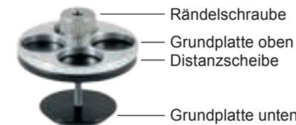
**! Vorsicht:** Den Fugenchip auf Abdichtungsmassen und elektrischen Fußbodenheizungen nur mit geschlossenen unteren Grundplatten verwenden, da ansonsten eine Verletzung des unter Materials durch die Rändelschraube besteht.
