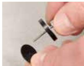
Eine Grundplatte oben und eine Grundplatte unten mit einer M2-Rändelschraube verbinden. Den Zwischenabstand auf mindestens Fliesenstärke öffnen (siehe Bild).
